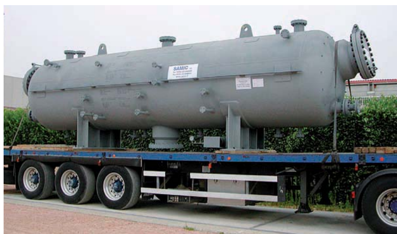
Convertitore realizzato in materiale AISI 308H con procedimenti di saldatura a Tig, elettrodi rivestiti e semiautomatico MIG. È il cuore degli impianti di produzione di acido solforico.
