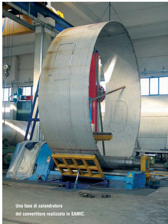
Convertitore realizzato in materiale AISI 308H con procedimenti di saldatura a Tig, elettrodi rivestiti e semiautomatico MIG. È il cuore degli impianti di produzione di acido solforico.
