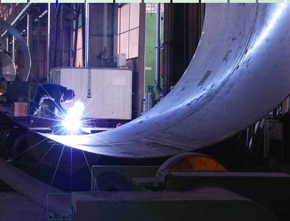
Saldatura di un recipiente a pressione in costruzione.
