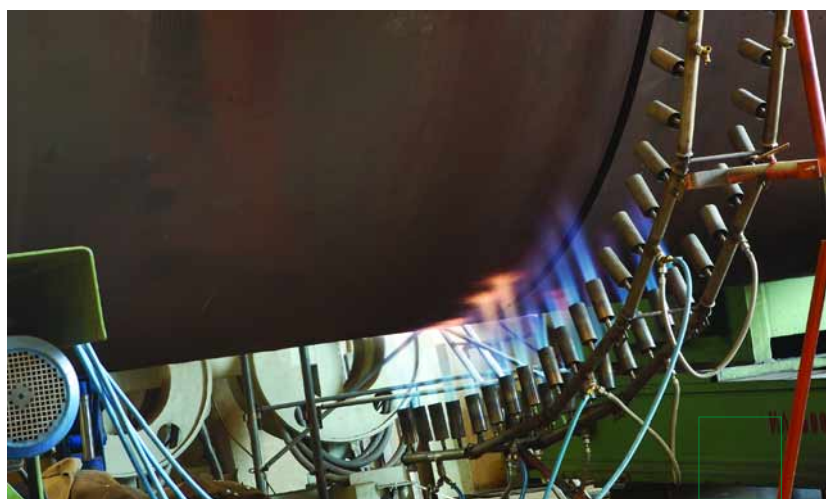
Fase di preriscaldamento del manufatto.
