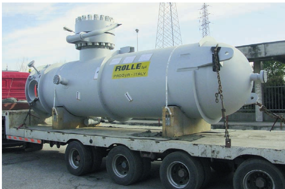
Fig. 2 Gas scrubber: reattore ad alta pressione
