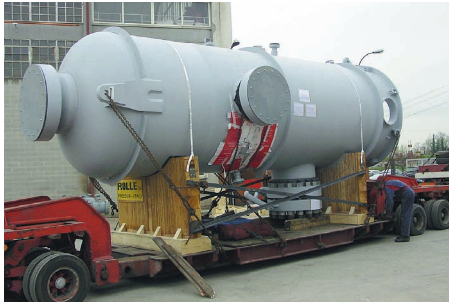
Fig. 5 Seal gas buffer: reattore ad alta pressione.
